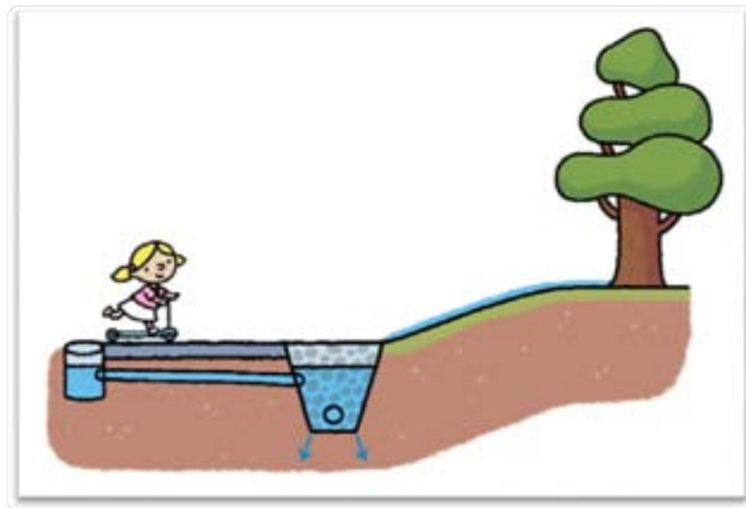
Figure 11 Exemple d'une tranchée d'infiltration (Source : Guide pratique Aménagement et eaux pluviales sur le territoire du Grand Lyon)
